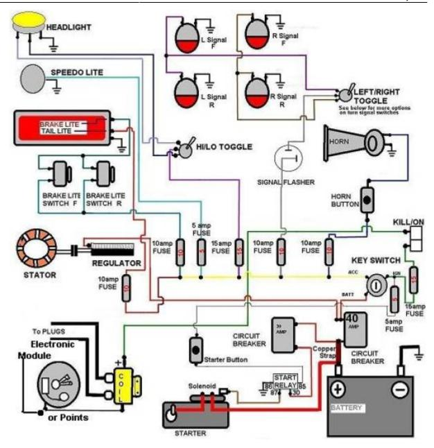
Ironhead CAD Wiring Diagram ('77) 4)
