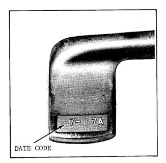
CORRECT BRAKE PEDAL SHOWING DATE CODE
