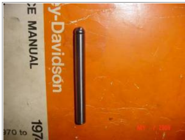
Homemade check ball lapping tool 15)
